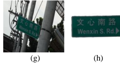
圖十二：(g)傾斜之路牌 (h)傾斜校正結果
