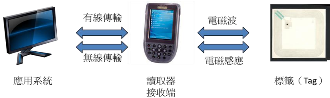
圖 2、RFID 系統架構
