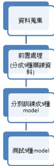
圖 2. 定位模型建立流程圖
