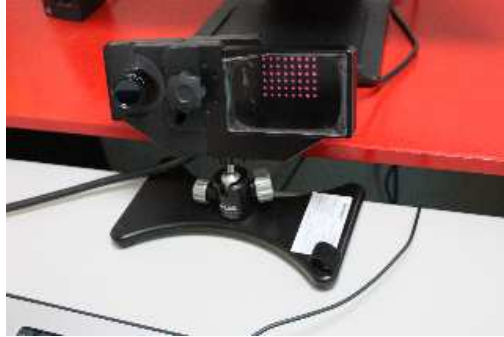
圖 1：急速眼球運動解析裝置 EyeLink CL。
