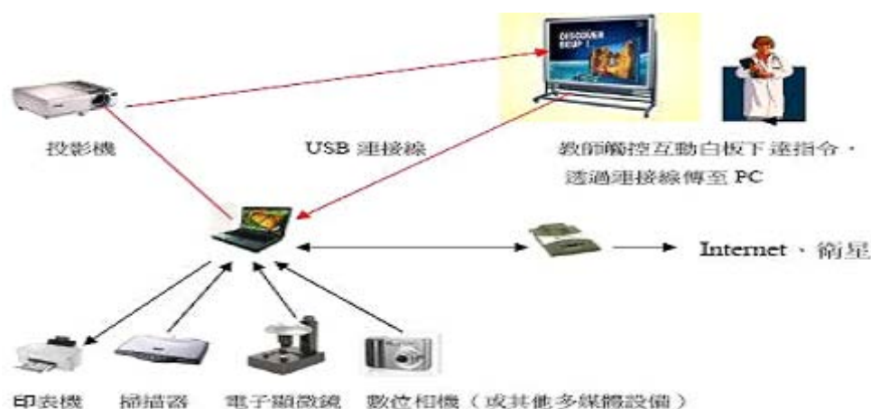
圖一、互動電子白板架構及其運作原理圖，陳惠邦 (2006)
