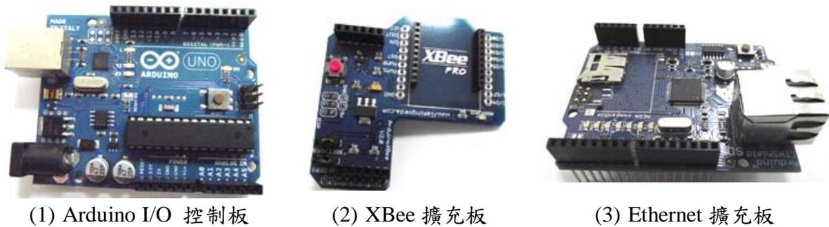
圖 2 Arduino I/O 控制板與擴充板
